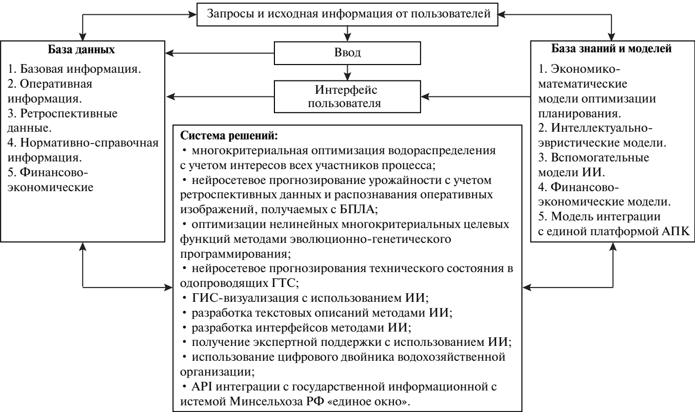
Рис. 1. Структурно-функциональная схема ИАС «Водопользование ОС»
