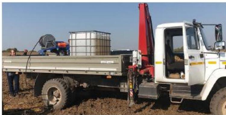
**Рис. 4. Бортовой автомобиль с емкостью для воды и высоконапорной гидравлической насосной станцией**
