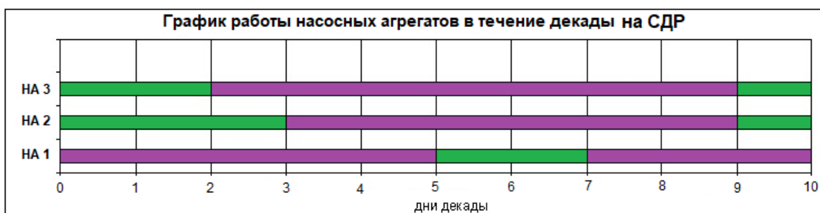
Рисунок 5 – Пример графиков работы насосных агрегатов насосной станции, полученных по результатам моделирования
