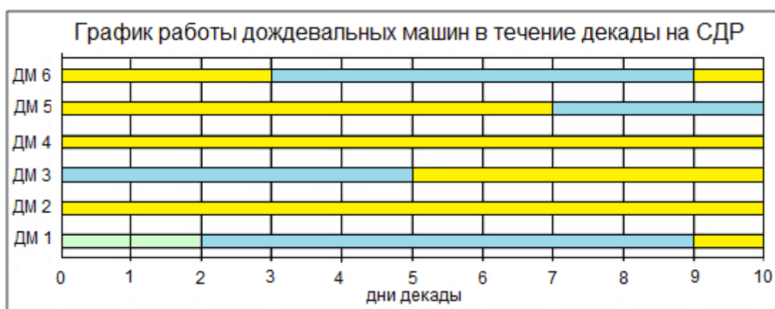
Рисунок 4 – Пример графиков работы дождевальных машин в течение интервала регулирования, полученных по результатам моделирования
