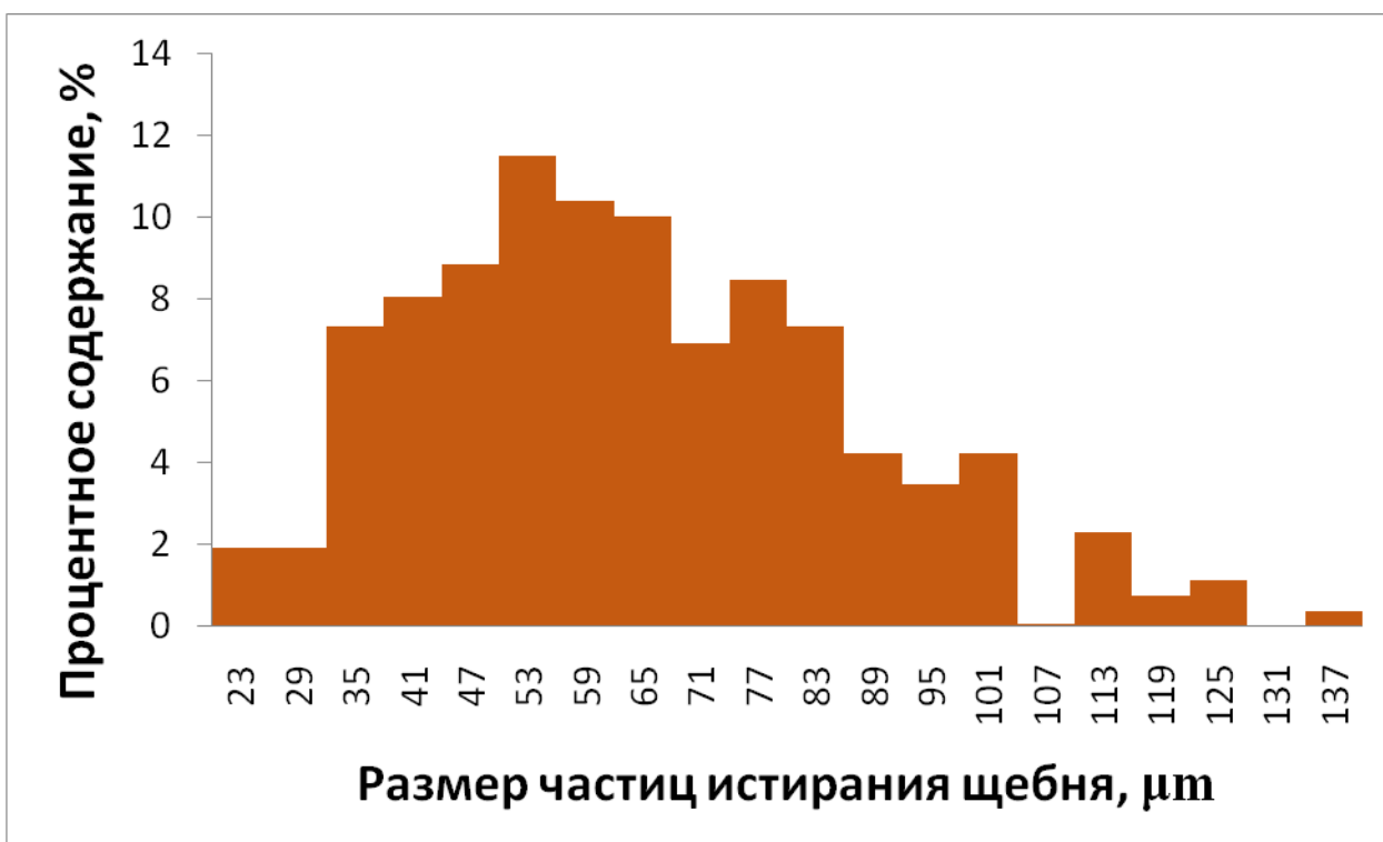
Рис. 3. Гистограмма распределения частиц истирания щебня по размерам для одного из образцов.
