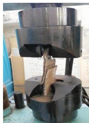
**Рис. 3. Испытания на разрыв бетонного полотна**
