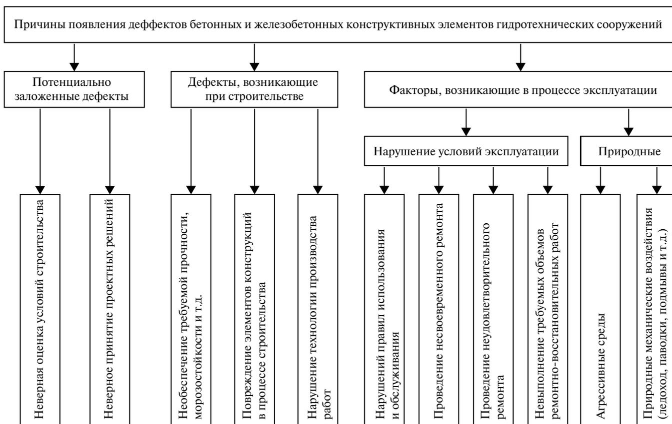
Рис. 2. Причины появления дефектов в бетонных и железобетонных конструкциях ГТС мелиоративных систем
