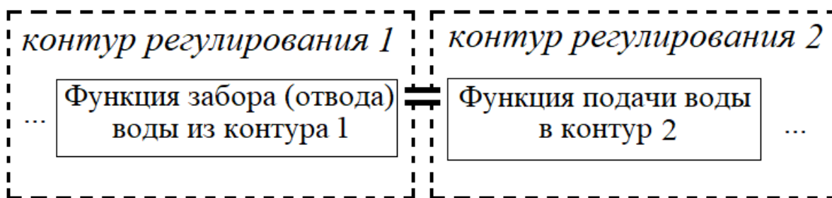
Рисунок 2 – Выделение начальных контуров регулирования в осушительных СДР
